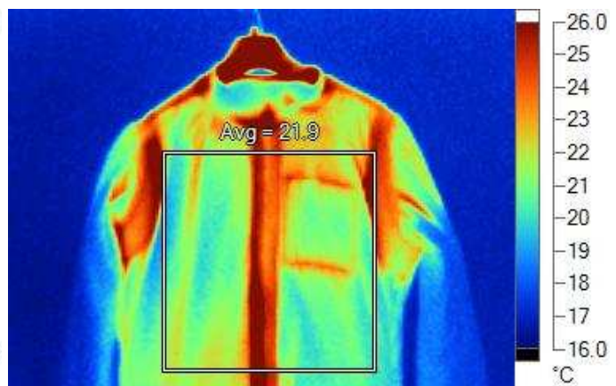
Obraz termiczny po 60 minutach podgrzewania wnętrza ocieplacza
