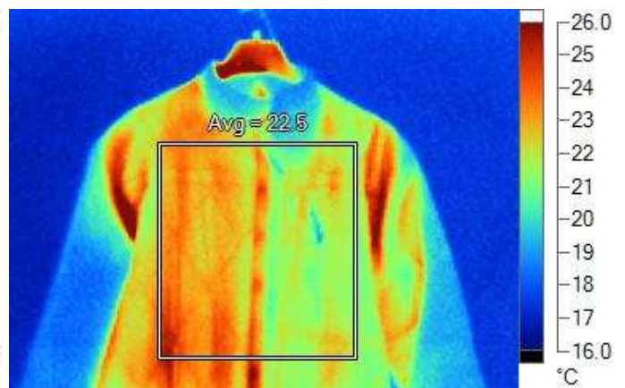
Obraz termiczny po 60 minutach podgrzewania wnętrza ocieplacza
