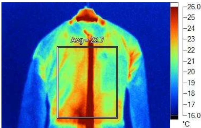
Obraz termiczny po 40 minutach podgrzewania wnętrza ocieplacza.
