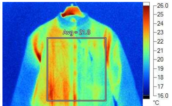
Obraz termiczny po 40 minutach podgrzewania wnętrza ocieplacza.
